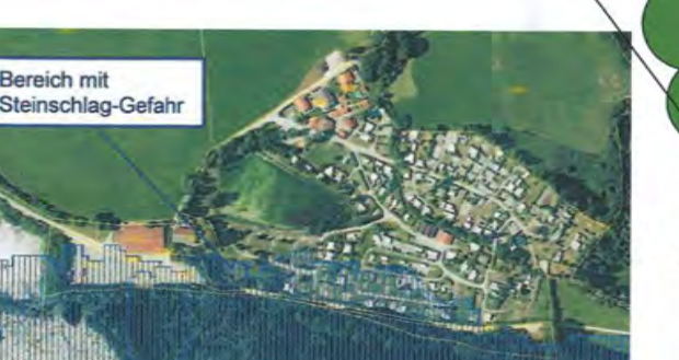
Abbildung Bereich Steinschlaggefahr, sowie der waldrechtlich notwendige Abstand von Gebäuden, die zum dauerhaften Aufenthalt von Menschen geeignet sind.
